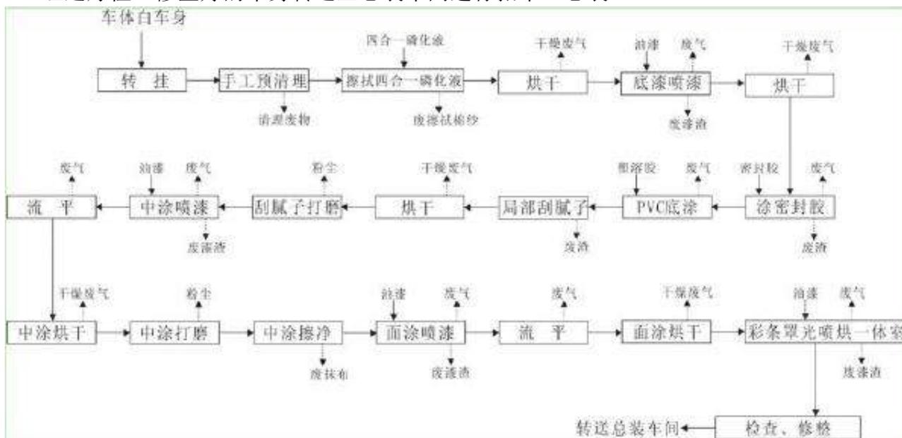
带排污节点的车体白车身涂装工艺流程图
