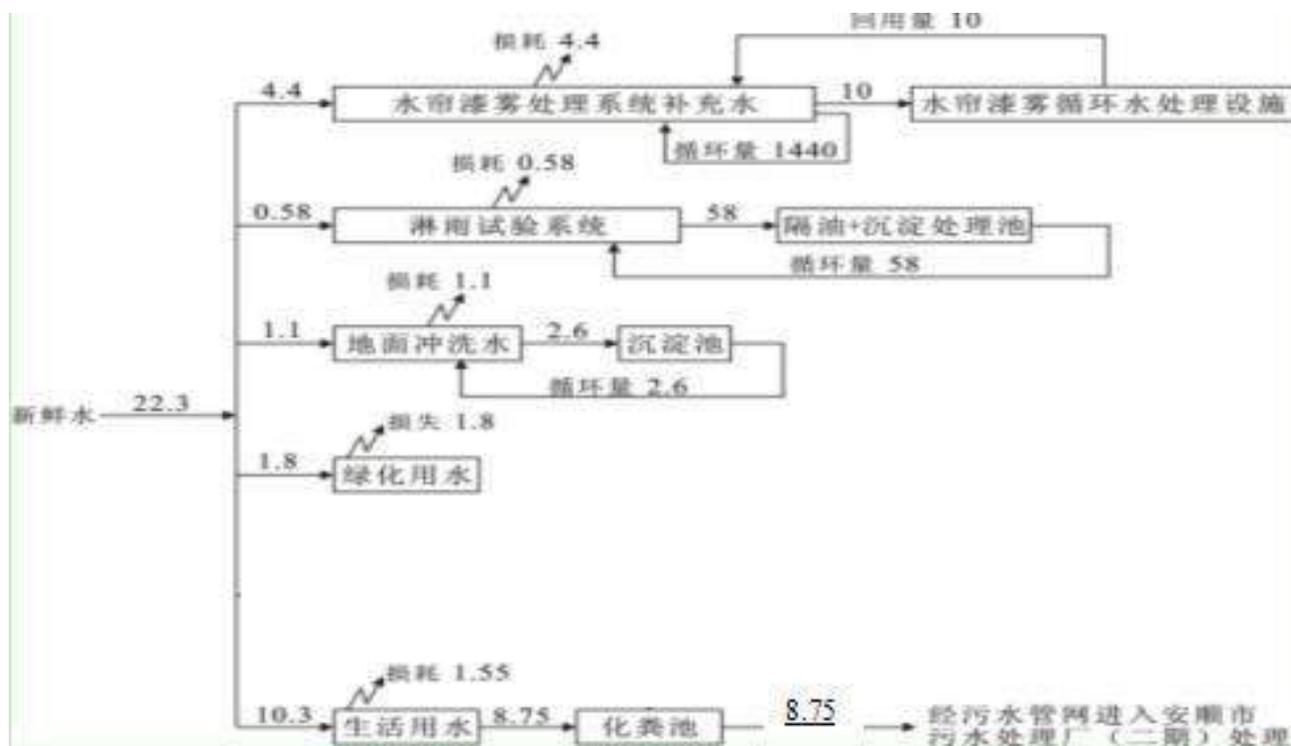
项目水平衡图 (单位: m³/d)
